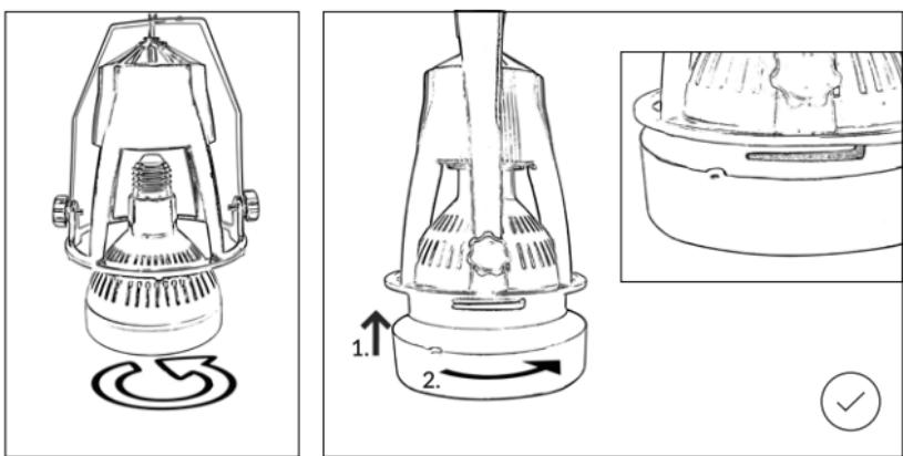
4. **PL** Żarówka została poprawnie zamontowana do holdera.
