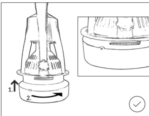
5. **PL** Żarówka została poprawnie zamontowana do holdera.
